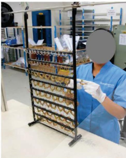
Figura 2 - Preparazione dei supporti da immergere in bagni di cromo. (Fonte: Souriau-Esterline, ECHA (2016))
