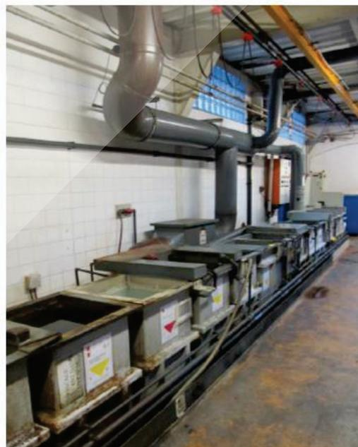
I bagni sono aperti e vengono utilizzati abbattitori di nebbia. Quando si immergono i supporti con gli articoli metallici nei bagni, il lavoratore si trova a una distanza inferiore a 1 m. Il tempo di permanenza nel bagno dipende dallo spessore richiesto del rivestimento finale.
